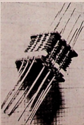
Micromodules (Siemens) tot blokje samengesteld.
